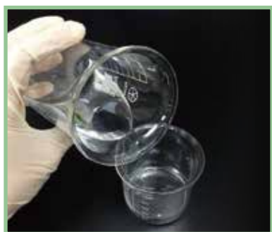
1. 取檢體液 20ml 檢體液 倒入 50ml 小燒杯中
