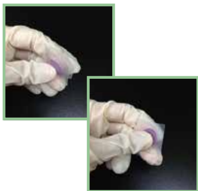
4. 取出測試片後將另一端錫箔紙撕 開，並將兩圓圈合起來以雙指按 住3分鐘即可進行結果判讀。
