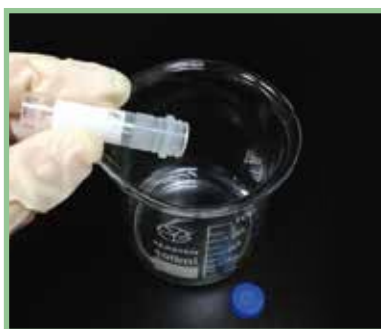
2. 將小試管中試劑全部倒入 燒杯中，攪拌3分鐘。
