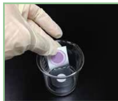
3. 將測試片白色部分全部浸泡至 燒杯溶液中，浸泡5分鐘。
